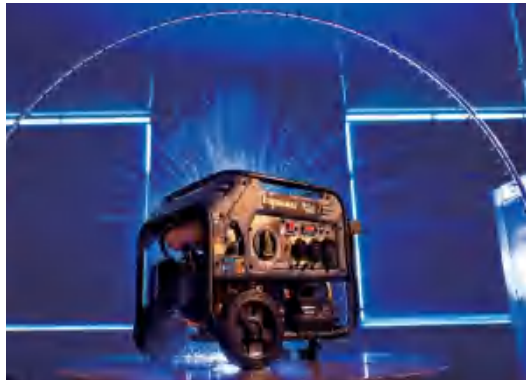
发电机雨淋测试
